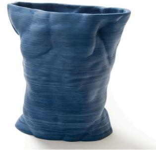
La technologie **Robocasting** consiste à extruder une pâte chargée de particules céramiques au travers d'une buse et au moyen d'une vis ou d'un piston. La filière d'extrusion, généralement de petit diamètre est pilotée pour déposer un motif sur un support plan à partir d'un filament de pâte puis à renouveler l'opération pour le plan supérieur.
