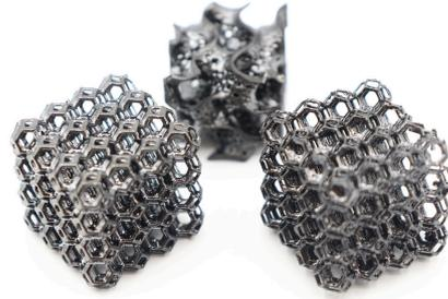
Issue des travaux de recherche menés à l'Institut de Recherche sur les Céramiques (IRCER, UMR CNRS 7315), cette technologie de fabrication de céramiques 3D utilise le principe de la **stéréolithographie laser (SLA)** : l'objet est construit en couches successives en utilisant un laser UV qui polymérise une pâte composée de résine photosensible et de céramique.
